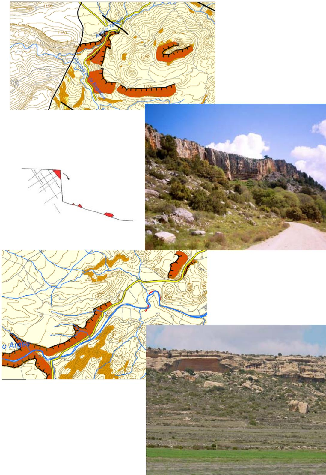
Figura 17. Ejemplos de cartografía de susceptibilidad por desprendimientos rocosos. En los mapas se han marcado linealmente los frentes de escarpe y las zonas afectadas por caídas de bloques.
